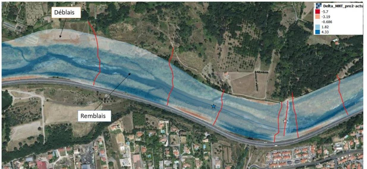
Figure 29 : Exemple de comparaison de MNT avec localisation des zones de déblais (en rouge) et de remblai (en bleu)
